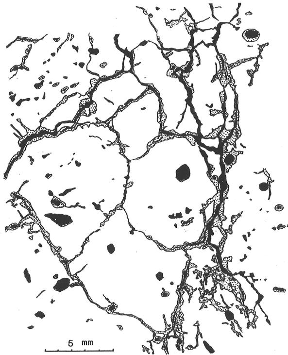
☐ fissures    ● pores créés par les racines    ▨ revêtements d'argile
